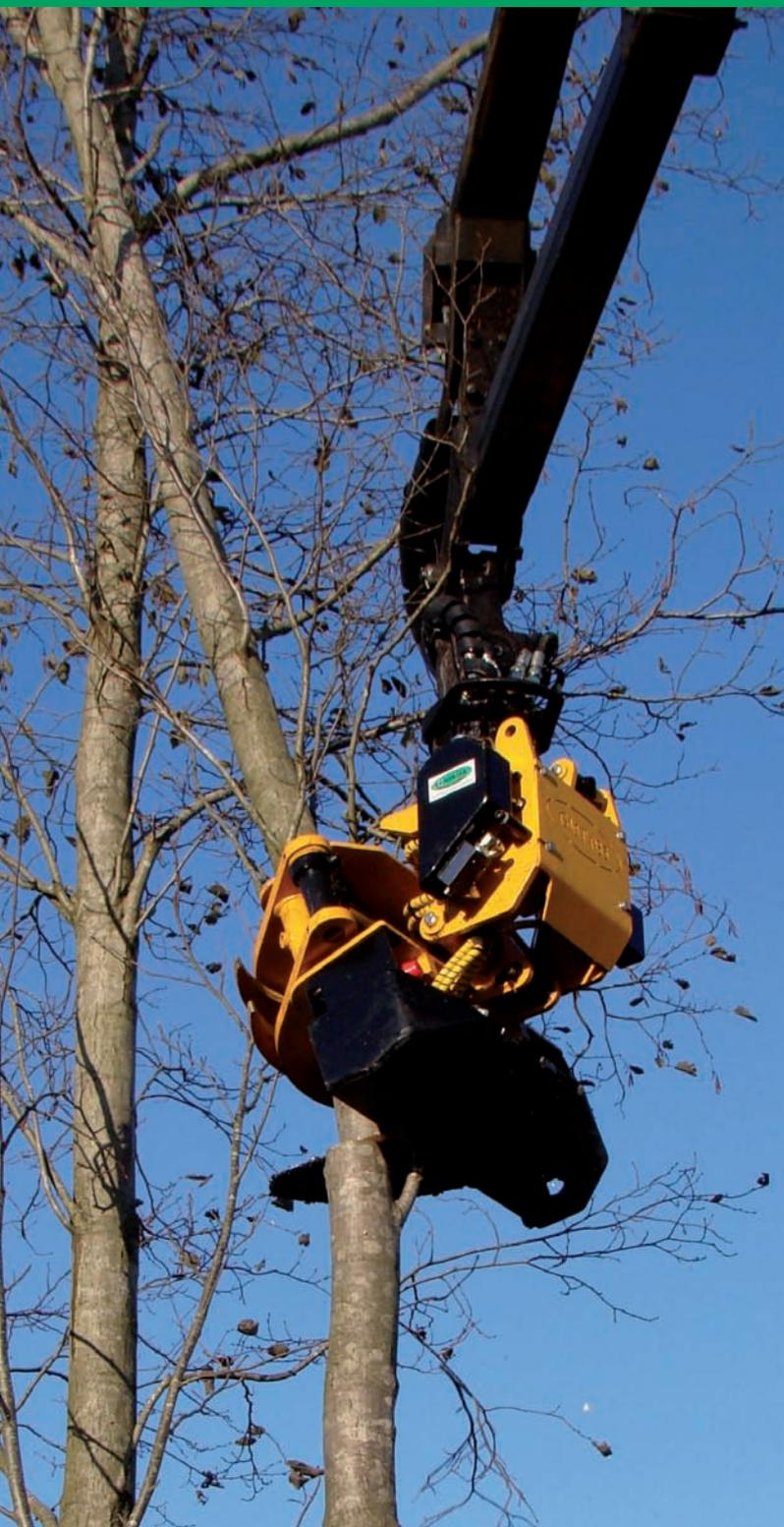
Der neue Fällkopf GMT035 kann ohne technische Anpassungen auf jeden Kran, LKW Kran oder Bagger montiert werden wo eine Holzzange montiert ist oder montiert werden kann. Dank dem patentierten Hydraulik-Steuersystem sind keine weiteren Schläuche oder Steuerkabel notwendig.
